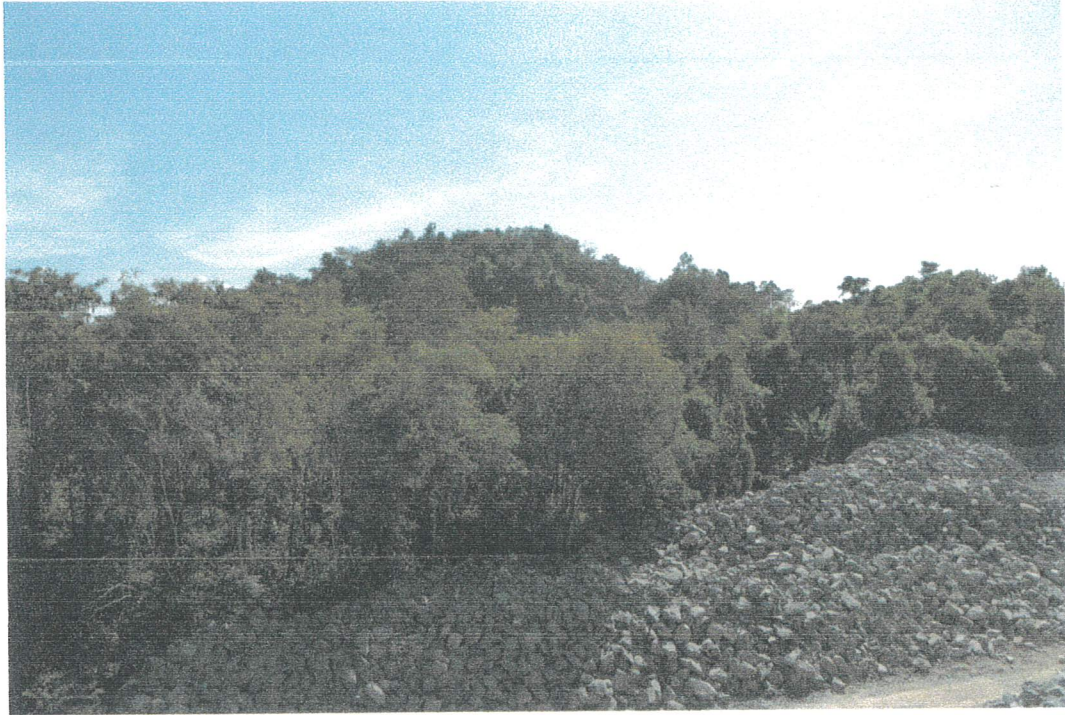
รูปที่ 4 การปลูกพืชคลุมดินบริเวณกองเปลือกดินเพื่อไม่ให้เกิดการพังทลาย
